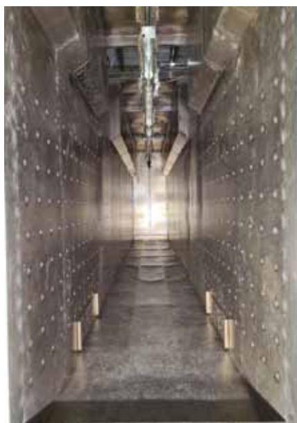
Superugnen som är den första i sitt slag, med 300st dysor hettar vi upp tjockt gods på nolltid.
